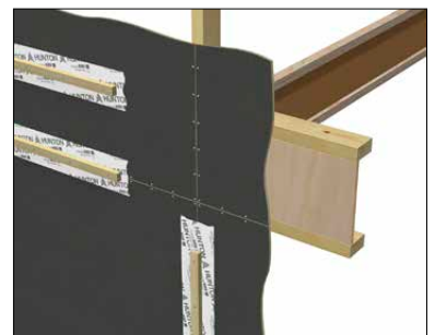
Klemming av skjøter m/tape
