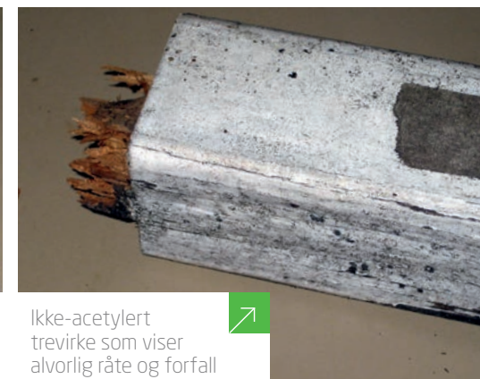
Ikke acetylert trevirke som viser råte og forfall
